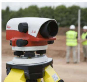
8 Сурет – Нивелир Leica NA724
